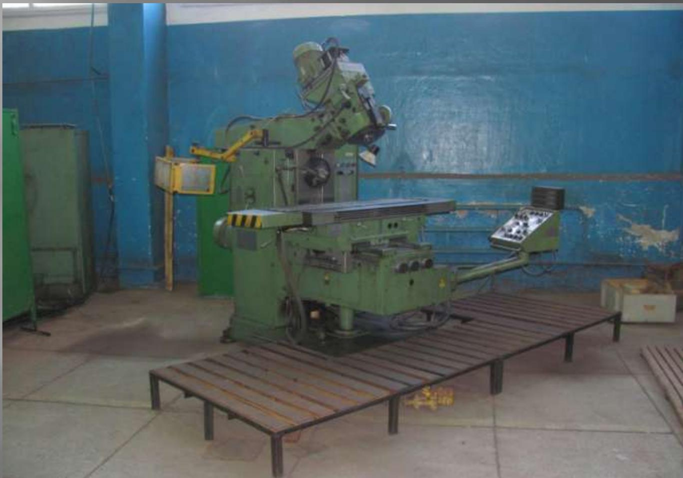
**Предназначен для выполнения фрезерных работ на деталях из чугуна, стали и других материалов цилиндрическими, торцевыми, концевыми, фасонными и другими фрезами**
