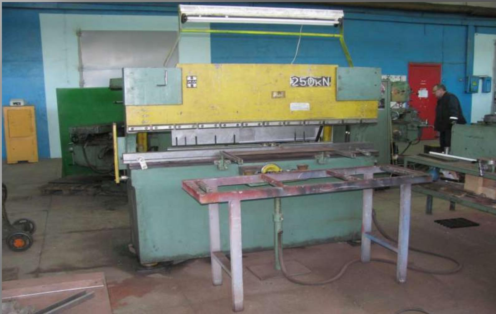
Предназначен для гибки листового материала, штамповка отверстий круглого и прямоугольного сечения – при наличии приспособлений
