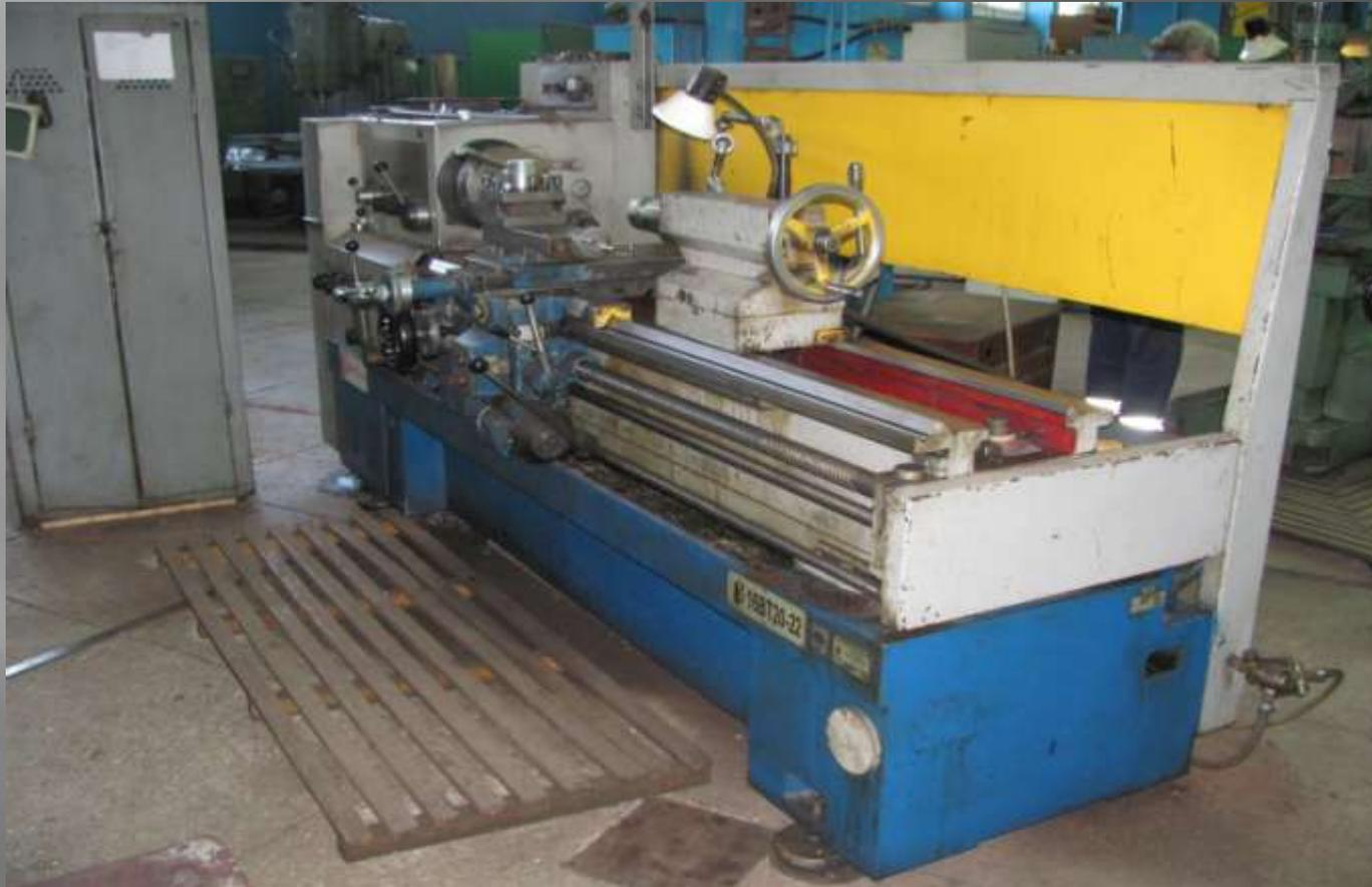
Предназначен для выполнения разнообразных токарных работ, в том числе - для нарезания резьбы: метрической, дюймовой, модульной, винтовой
