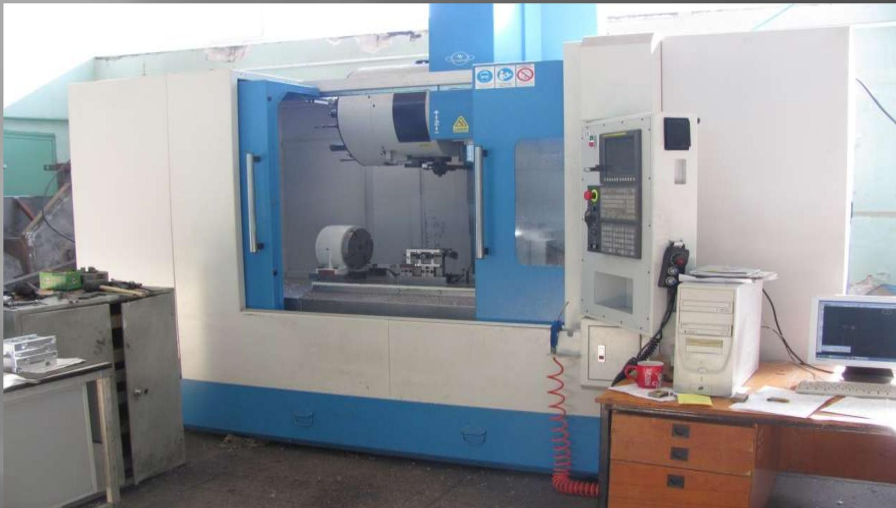
**Предназначен для высокоточной обработки среднегабаритных деталей из различных материалов в осях X; Y; Z. Обеспечивает высокую скорость и чистоту обработки**
