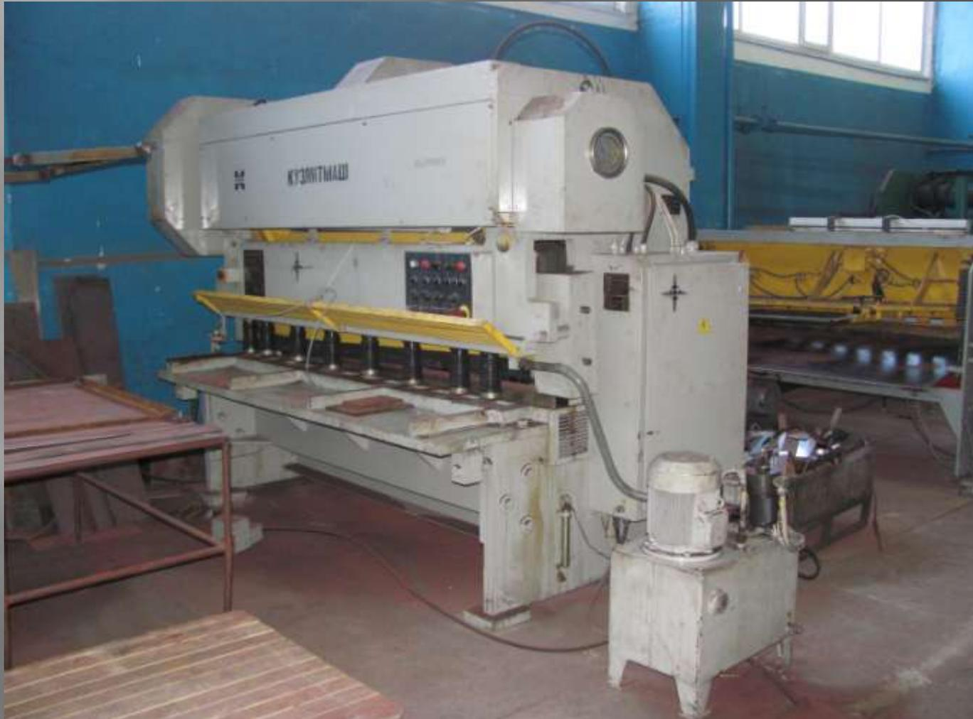
Предназначен для резки листового, полосового, сортового и фасонного проката и пробивки отверстий в нем
